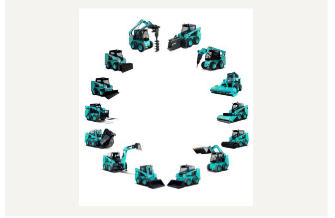
Mini Yükleyici Atışmanları (Skid Steer Loader's Attachments)
